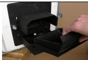
Fot.3. Czyszczenie tygla palnika QPell
