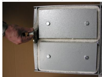
Fot.9. Wymiana uszczelki ceramicznej drzwiczek
